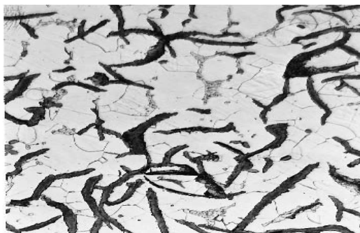
Фиг.1 Лята структура на легиран с Мо и В сив чугун (x400)
